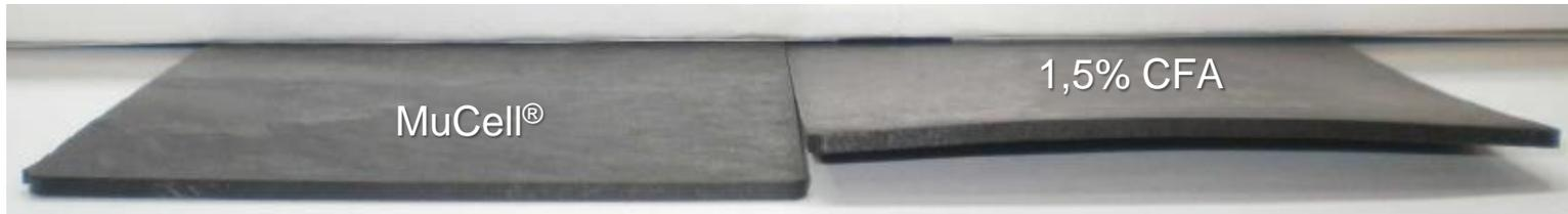
Vergleich Verzugs minderung 3mm Testplatte Material PP GF15
