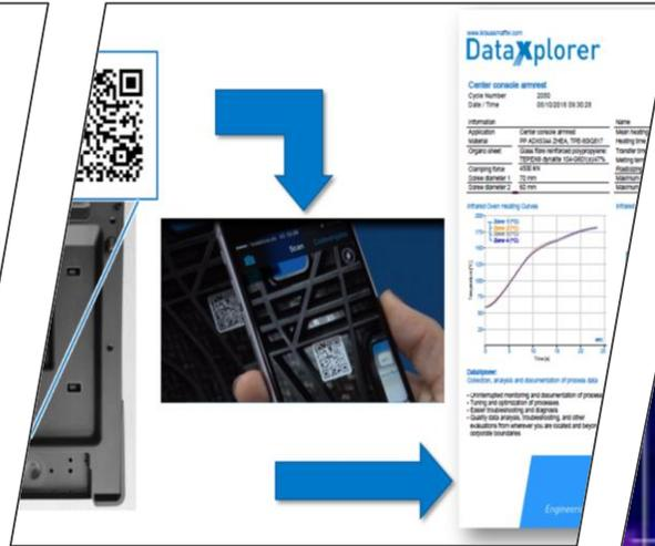
Prozessparameter werden für jedes Teil verfolgt und aufgezeichnet
