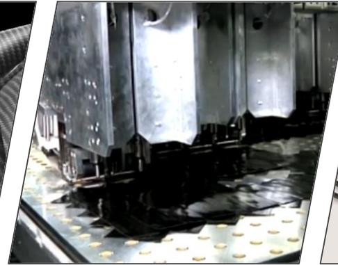
Maßgeschneidertes Design entsprechend den mechanischen Anforderungen, durch Bandverlegung (Fill)
